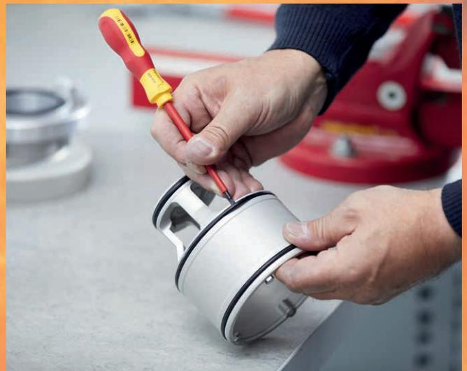
Dichtringe bei Bedarf tauschen. Danach Zusammenbau in umgekehrter Reihenfolge und Systemtrenner prüfen.
