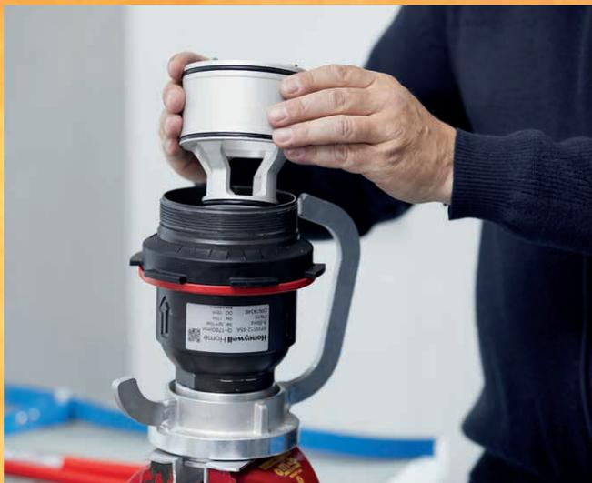
Kolben herausdrücken und entnehmen.
