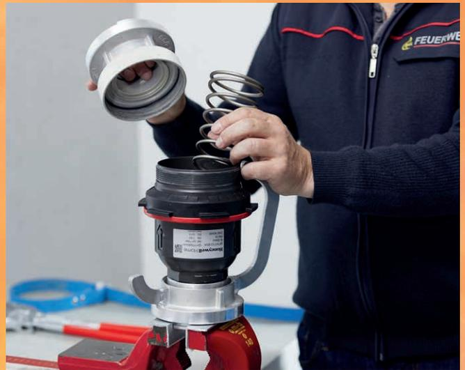
Deckel öffnen und die spannungsfreie Feder entfernen.
