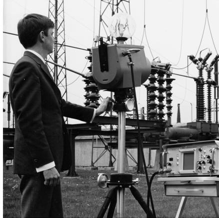
**Abbildung 20.2** 1969: Modell 661 der Thermovision. Die Kamera wog ca. 25 kg, das Oszilloskop 20 kg und das Stativ 15 kg. Für den Betrieb wurden darüber hinaus ein 220-Volt-Generator und ein 10-Liter-Gefäß mit flüssigem Stickstoff benötigt. Links neben dem Oszilloskop ist der Polaroid-Aufsatz (6 kg) zu erkennen.
