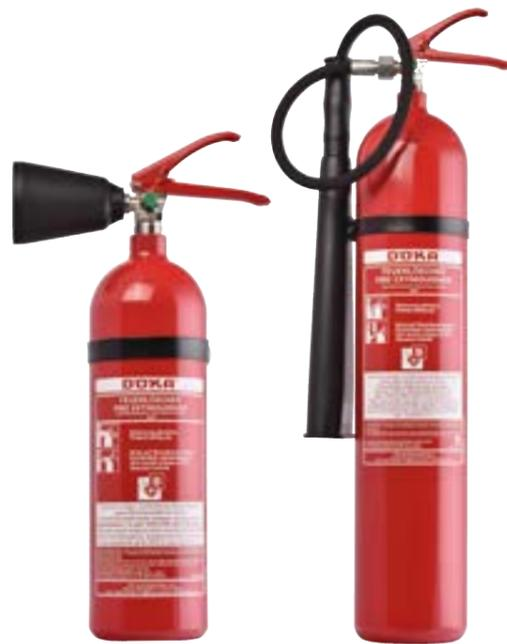
Unsere Kohlendioxidfeuerlöscher verfügen über eine Ganzmetallarmatur mit vernickeltem Messingkörper. Die Modelle KS2CS-1 und KS 5CS-1 (mit Stahlflasche) und KS 5CA (mit Aluminiumflasche) sind ausgestattet mit einer hochwertigen Schlauchleitung und Schneerohr, bzw. Nebeltrichter mit Metall-Inlet. (KS2CS-1) Ein Spannband zur Montage des Feuerlöschers an der Wand und zur Aufnahme der Schlauchleitung ist bei allen Ausführungen serienmäßig.
