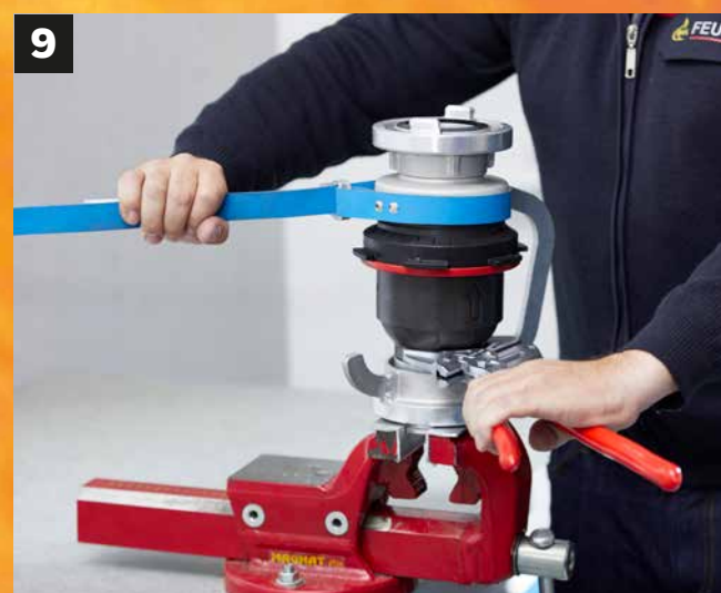
9 Deckel verschrauben und Systemtrenner mit TKA112 Prüfset testen
