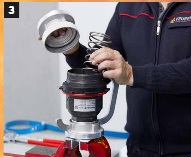
3 Spannungsfreie Feder entfernen
