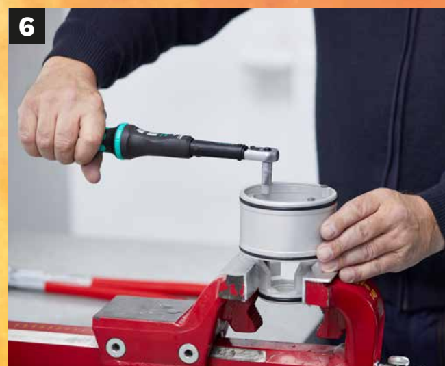
6 Kolben vorsichtig in Schraubstock einspannen und 4 Schrauben lösen
