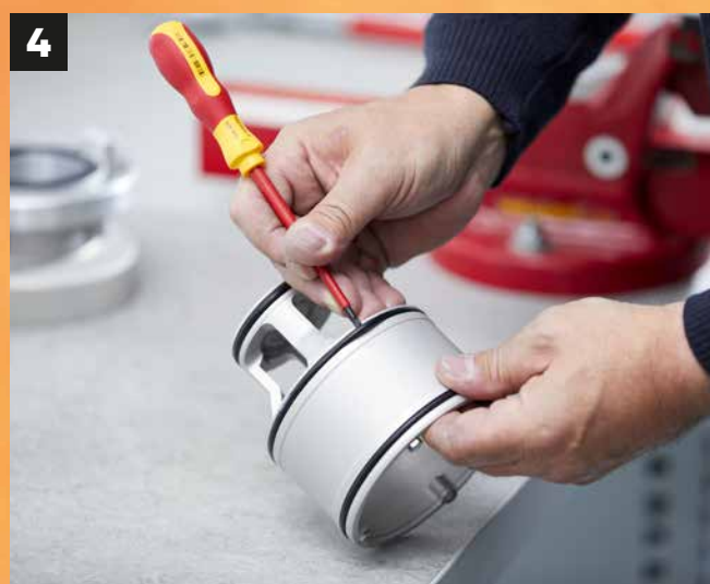
4 O-Ringe prüfen und ggf. mittels Schraubendreher entfernen
