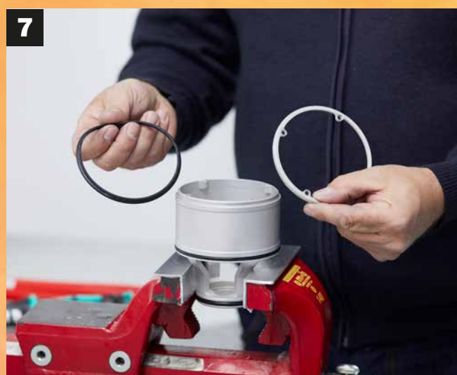
7 Formdichtung entfernen, neue einlegen und 4 Schrauben über Kreuz anziehen (Drehmoment 4 Nm)
