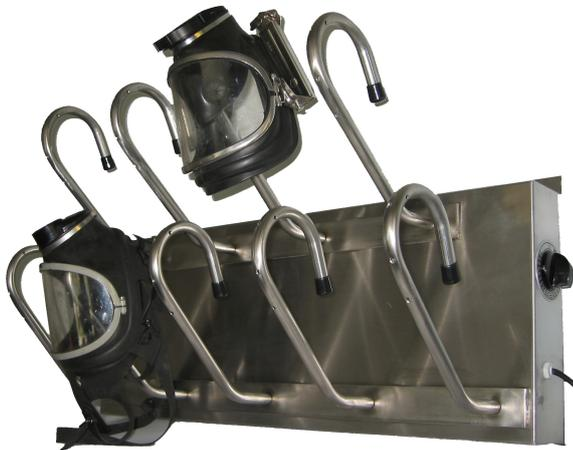
Die hygienische Trocknung von Schutzmasken mit einer Trocknungszeit von zirka ein bis zwei Stunden. Durch genaue Anordnung der Luftdüsen und den idealen Rundbögen am Ende der Halteorgane, wird exakt jeder Teil der 8 oder 9 Masken mit dem warmen Luftstrom erreicht und schonend getrocknet.
